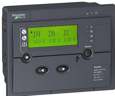
В зависимости от требуемого уровня чувствительности, в Sepam 10 существует три типа земляных защит: стандартная, чувствительная и высокочувствительная. Их отличие заключается в уровне уставки по току нулевой последовательности. Учитывая тот факт, что большинство сетей 10(6) кВ на постсоветском пространстве выполнены с изолированной нейтралью, а значит токи замыкания на землю в них небольшие, рекомендуется использовать чувствительный тип земляной защиты Sepam 10.
