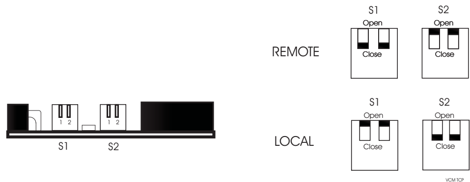
Рисунок 8.3.1-2 VCM TCP– микропереключатели модулей ЛОКАЛЬНЫЙ для порта связи 2; ДИСТАНЦ. Для порта 1)
