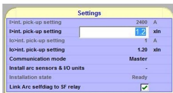
Рисунок 6.50: Пример определения значения уставки срабатывания I.
