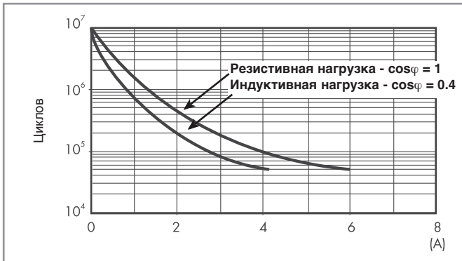
F 32 - Электрическая долговечность (AC) при ном. нагрузке
