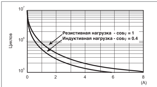
H 4C - Макс. отключающая способность DC1
