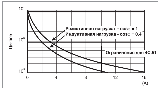
F 4C - Электрическая долговечность (AC) при ном. нагрузке, Типы 4C.01/51
