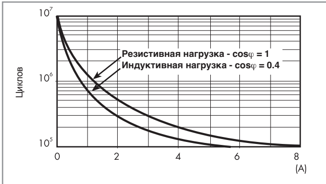
F 50 - Электрическая долговечность (AC) при ном. нагрузке
