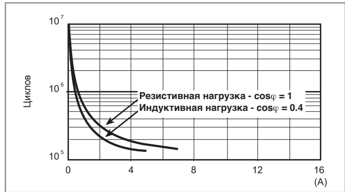
F 58 - Электрическая долговечность (АС) при ном. нагрузке, Реле с 4 переключающими контактами
