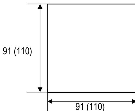
Примечание – без скобок указаны размеры окна для крепления измерительных преобразователей конструктивного исполнения Е, в скобках – для крепления измерительных преобразователей конструктивного исполнения Р.
