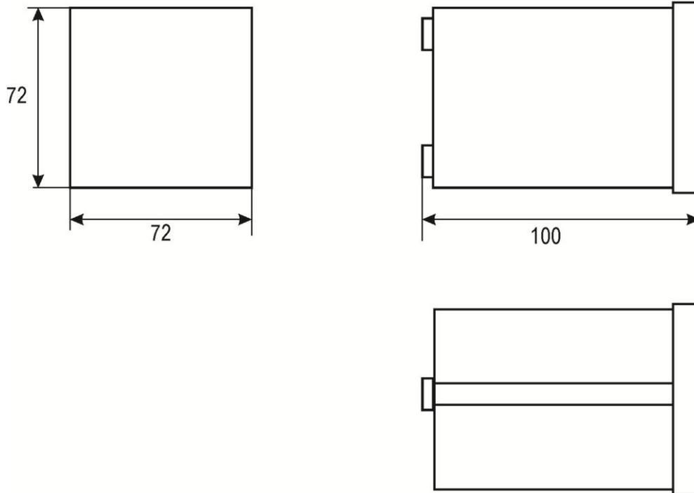
Рисунок Б.1 - Габаритные размеры измерителя
