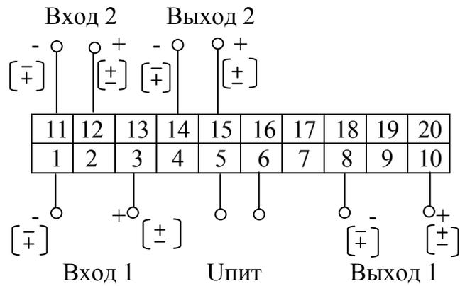
Рисунок А.3 - Схема электрическая подключений двухканальных измерительных преобразователей
