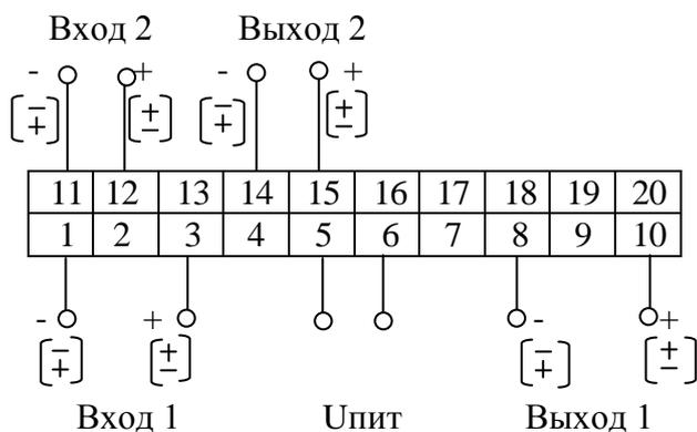
Рисунок Б.2 – Схема электрическая подключений двухканальных ИП (кроме модификаций –Ц)
