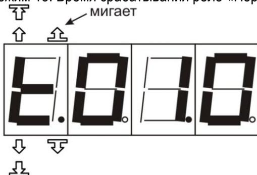
«Время срабатывания реле «Переключение вверх»» - время, на которое сработает реле при переключении датчика в положение с более низким номером. Параметр может находиться в пределах от 0.1 до 25.0 секунды. По умолчанию 1.0 секунды.
