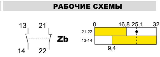
**AFT2T38X11: металлический толкатель с регулируемым нейлоновым роликовым толкателем Ø22 мм**
