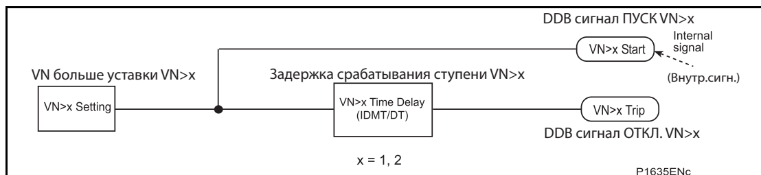
Рисунок 28: Логика защиты по напряжению нулевой последовательности (одна ступень)
