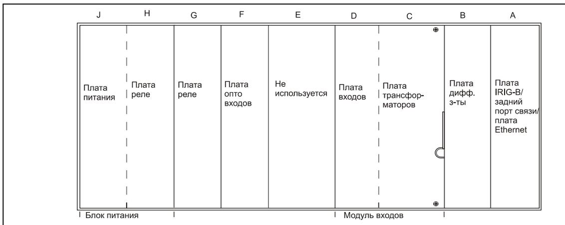
Рис. 6: Расположение модулей/плат P542 и P543 (вид спереди)
